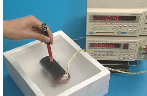
Fig. 1 超伝導体の磁気浮上実験。
